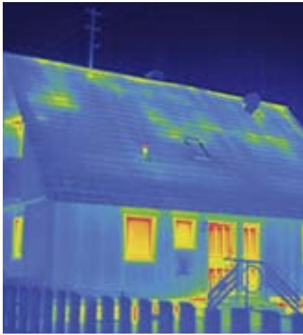
Gelb und Rot signalisieren – hier geht viel Wärme verloren
