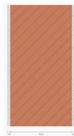
Vor Sanierung: U = 1,40 W/(m 2 ·K)
