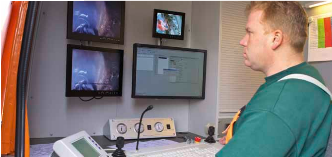
Live-Übertragung: Die aufschlussreichen Bilder aus dem Inneren der Rohre werden von Thomas Dreßen gleich kritisch unter die Lupe genommen
