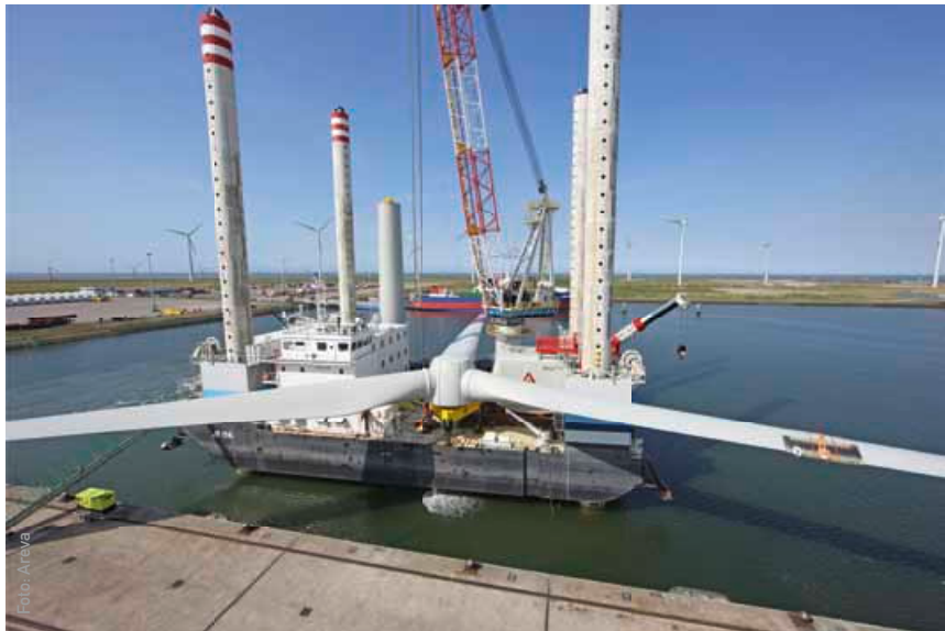
Transport und Montage der Windräder auf dem Meer erfolgen mit speziellen Schiffen. Jack-up-Plattform nennen Experten diese Montageeinheiten.
