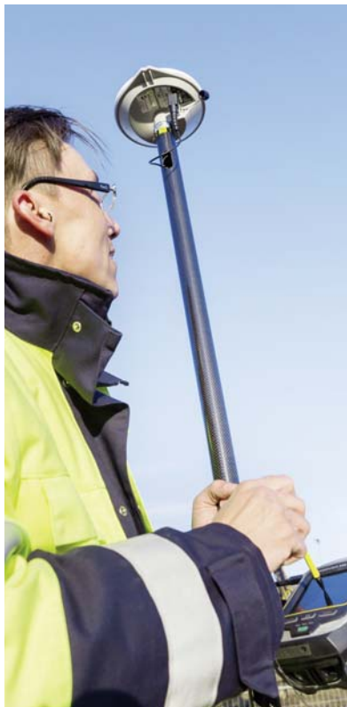
Mit einer zusätzlichen Antenne (oben auf der Stange) werden die Messergebnisse genauer.
