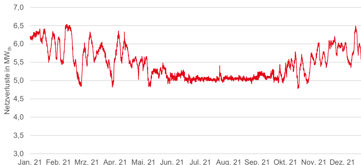
Abbildung 52: Jahresverlauf der Netzverluste auf Basis des Lastgangs von 2021
